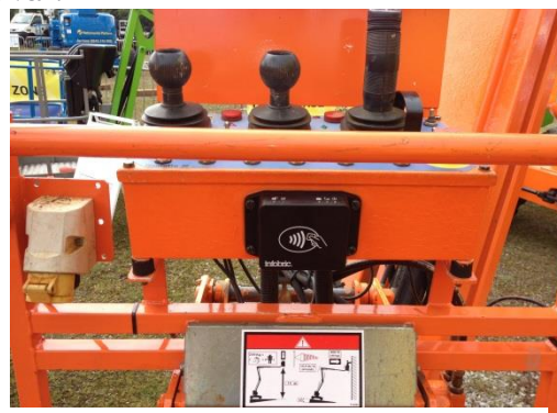
En MCR 610 monterad på en större bomlift.
